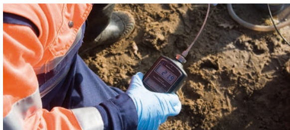
Doormeten filters na dosering hulpstoffen grondwater
